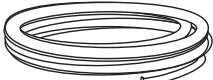
Línea de Agua Caliente— mínimo de 3/8", tubería de cobre (incluyendo abrazadera de refuerzo, tuerca de compresión) o Pieza de GE Appliances n° WX28X326, manguera trenzada flexible
