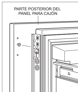
Montaje del panel del cajón
