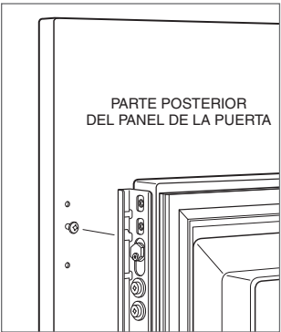
Montaje del panel de la puerta
