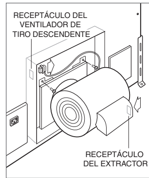
Montaje del extractor
